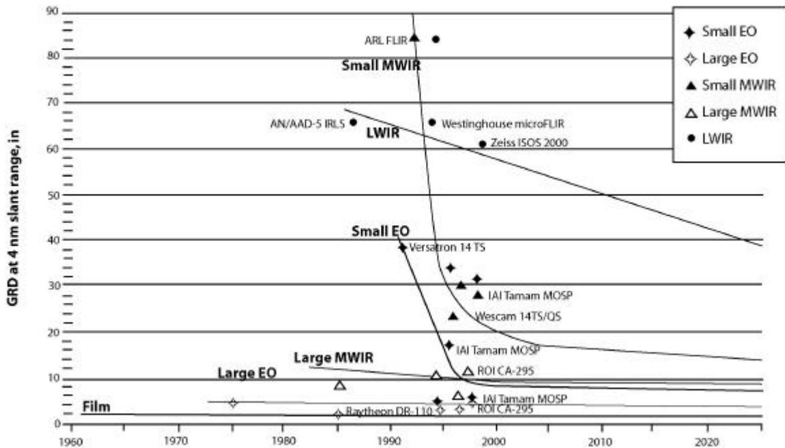
FIGURE 4.2.2-1: EO/IR SENSOR GROUND RESOLVED DISTANCE TREND.
